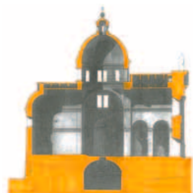
Foto 12 - Sezione in cui si vede dal basso la cripta, il santuario, il tamburo, la calotta e la lanterna finestrata
